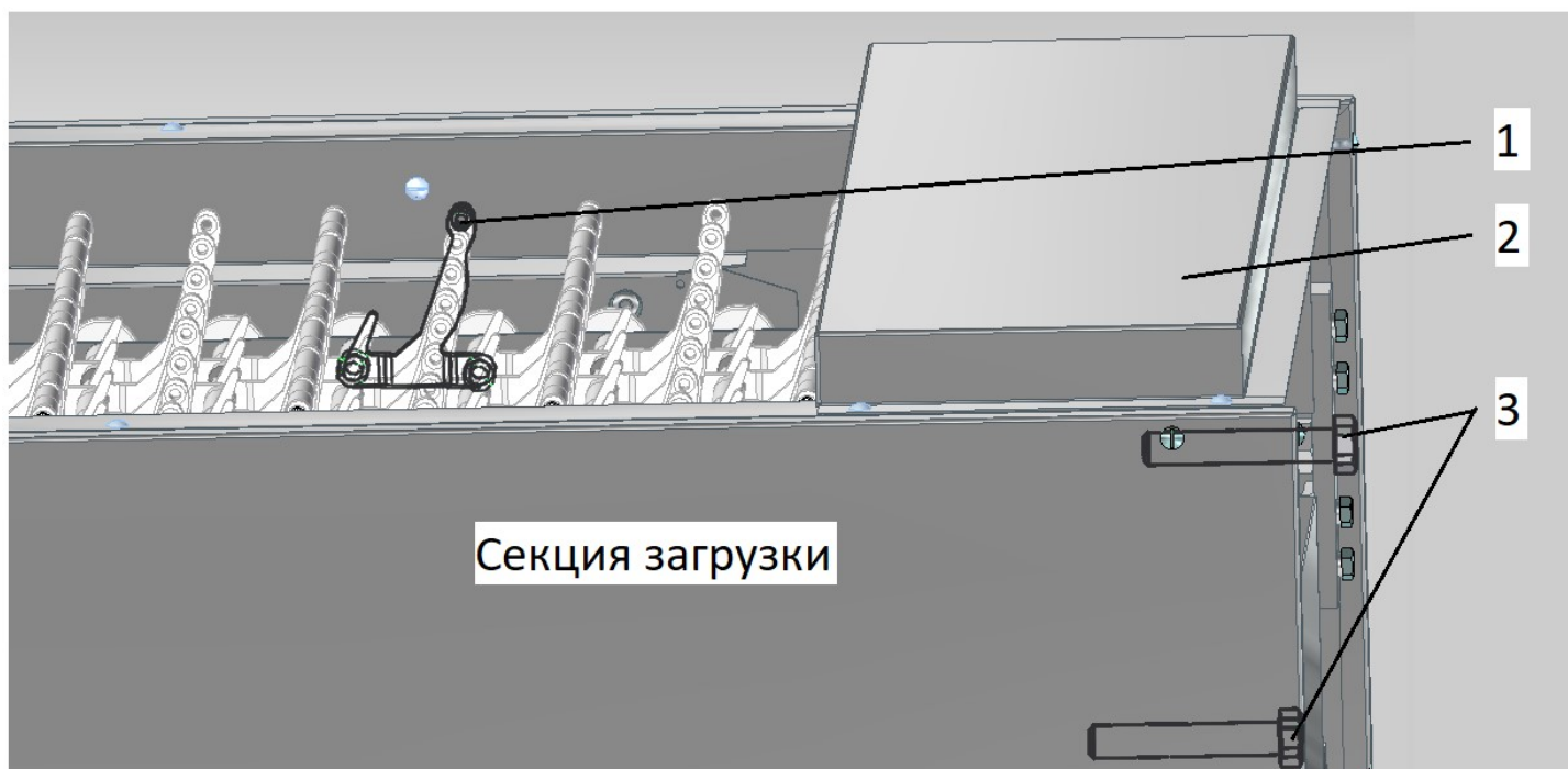
Рис. 11. Установка накладки межсекционной
